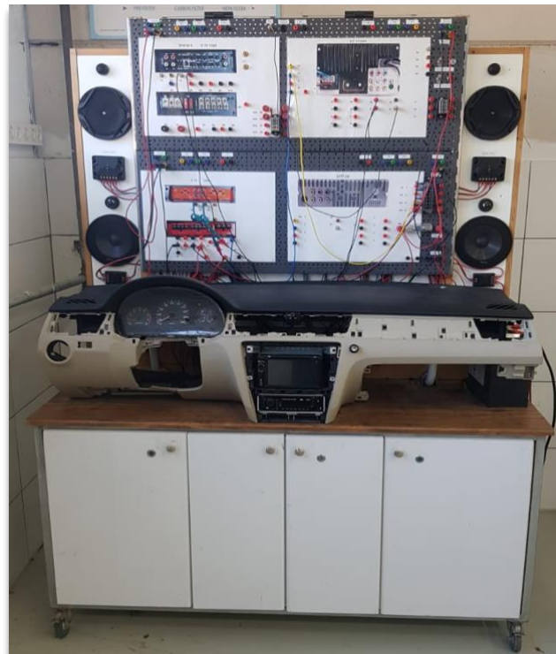
איור 4. דגם מערכת שמע וחיישני קרבה שנבנה על ידי צוות מורי המגמה
